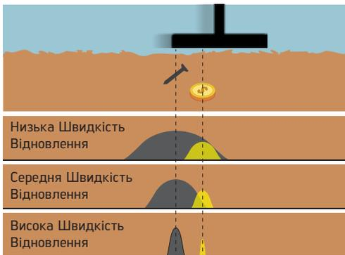
**ВАЖЛИВО!** Збільшення Швидкості відновлення забезпечує більш високу швидкість пошуку з меншою ймовірністю пропуску цілі. Збільшення Швидкості відновлення при тій самій швидкості пошуку може усунути шум від ґрунту, але зменшить глибину пошуку.
