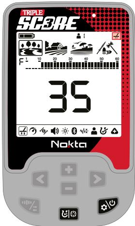
6. Если вы не можете выполнить балансировку грунта, это означает, что либо грунт слишком проводящий, либо он не минерализован, либо прямо под поисковой катушкой находится цель. В таком случае повторите попытку балансировки грунта в другом месте.
