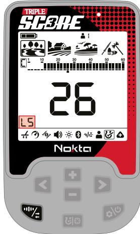
В модели TRIPLE SCORE в режимах "Парк", "Поле" и "Пляж" меню дополнительных настроек включает в себя следующие функции: настройка количества тонов, громкость железа, граница тона, пороговый тон, Отсечение крышки от бутылки, вибрация и светодиодный фонарик.
