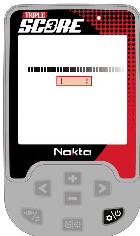
**ВАЖНО:** Если прибор не включается после завершения обновления программного обеспечения, а индикатор зарядки мигает, даже если устройство не подключено к USB, установку программного обеспечения необходимо выполнить повторно.
