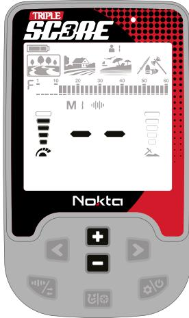
4. Если устройство шумит при увеличении настройки чувствительности, вы можете включить шумоподавление, нажав и удерживая кнопку «Частота и шумоподавление», прежде чем уменьшать настройку чувствительности.
