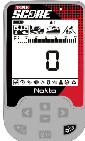
3. Вам необходимо прислушаться к звукам, доносящимся от земли, чтобы выполнить ручную балансировку грунта. Качайте поисковую катушку вверх и вниз с высоты примерно 15–20 см (~6–8 дюймов) над землей до высоты 3 см (~1 дюйм) от земли плавными движениями, удерживая ее параллельно земле.
