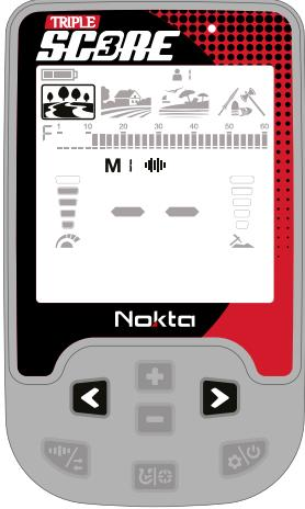
3) При необходимости вы можете увеличить чувствительность с помощью кнопок «Плюс» (+) и «Минус» (-). Увеличение чувствительности обеспечит вам большую глубину. Однако если окружающая среда или земля вызывают чрезмерный шум в устройстве, необходимо снизить настройку чувствительности.
