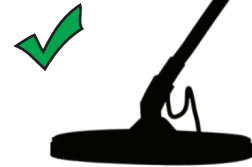
Правильный угол наклона поисковой катушки
