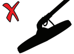
Неправильный угол наклона поисковой катушки
