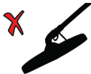
Неверный угол поисковой катушки к земле
