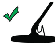
Правильный угол поисковой катушки к земле
