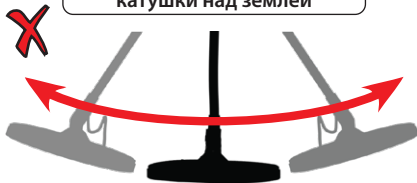
Неправильный проход катушки над землёй
