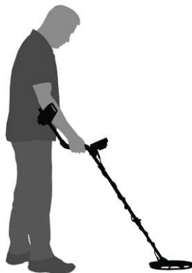
Высота штанги отрегулирована правильно
