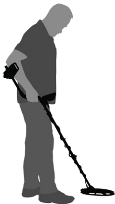
Высота штанги отрегулирована неверно
