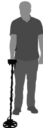
Высота штанги отрегулирована правильно
